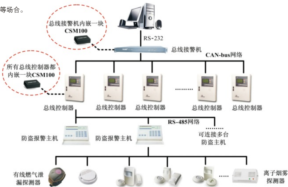
图 3 CSM100在安防系统中的应用
