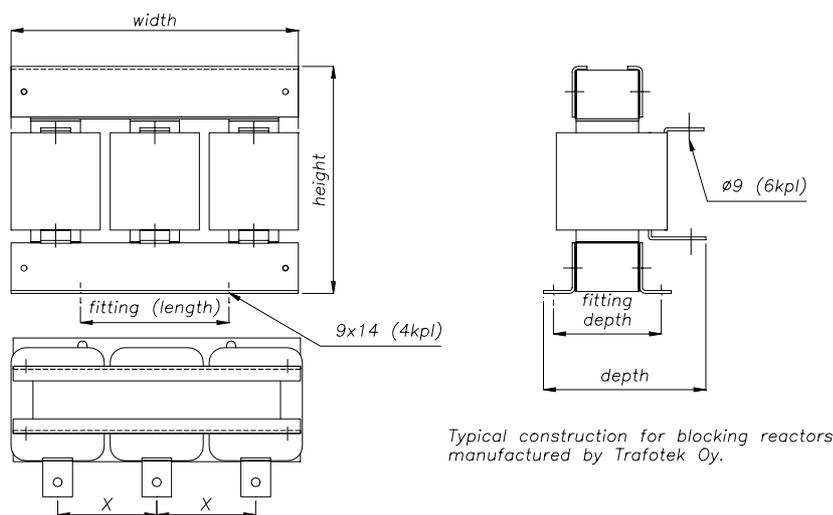
图一、典型的调谐电抗器构造
